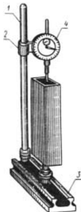
Прибор состоит из стойки 1, держателя 2, нижней опоры 3 и индикатора 4, позволяющего устанавливать изменение длины образца по сравнению с эталоном.
